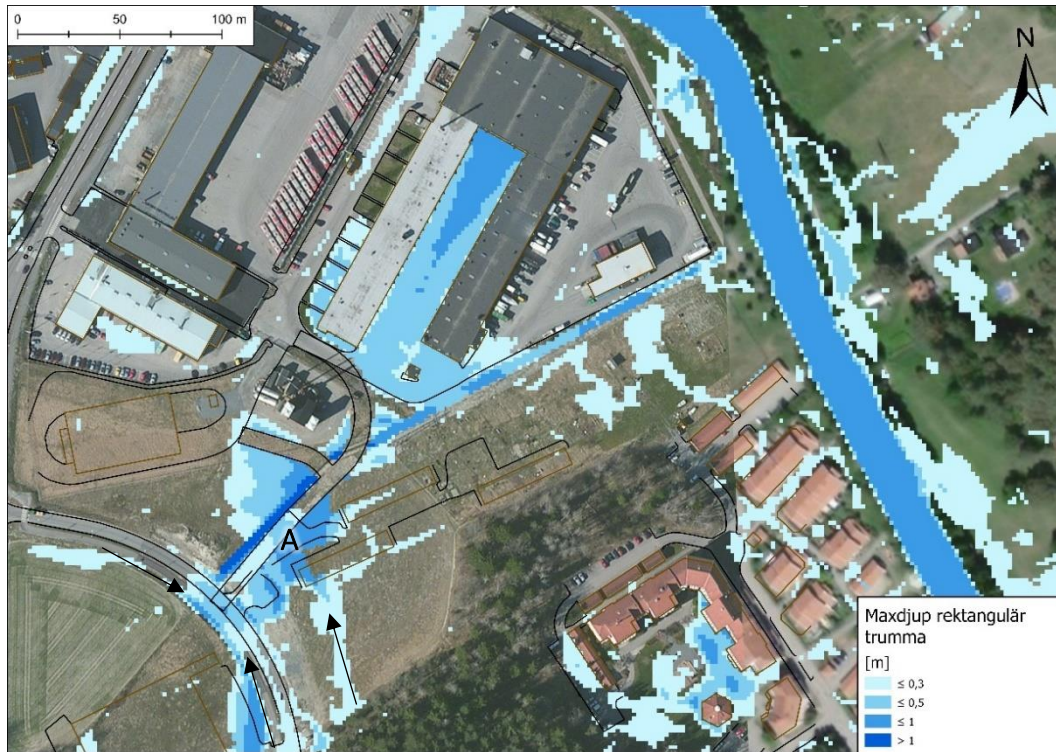
Figur 21. Visar maxdjup med en rektangulär trumma under den nya infarten. Pilar visar de större rinnvägarna till dike från uppströms områden.
