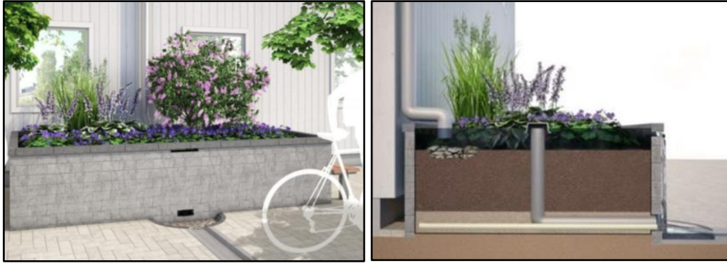
Figur 26 & 27. Exempel på upphöjd växtbädd som tar emot dagvatten från tak via stuprör (Vinnova, 2014).
