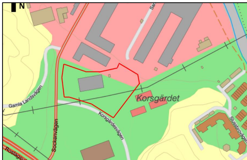
Figur 7. Markens genomsläpplig inom planområdet. Planområdet är markerat med en röd linje. Röd färg – hög genomsläpplighet, grön färg - låg genomsläpplighet (källa: SGU).
