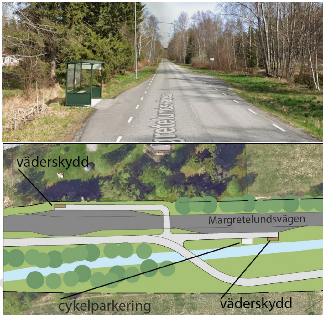
Figur 13, Befintligt hållplatsläge samt nytt utformningsförslag vid hållplatsläge Gårdslöten, bild från Google. Hållplatslägets placering redovisas i figur 11.
