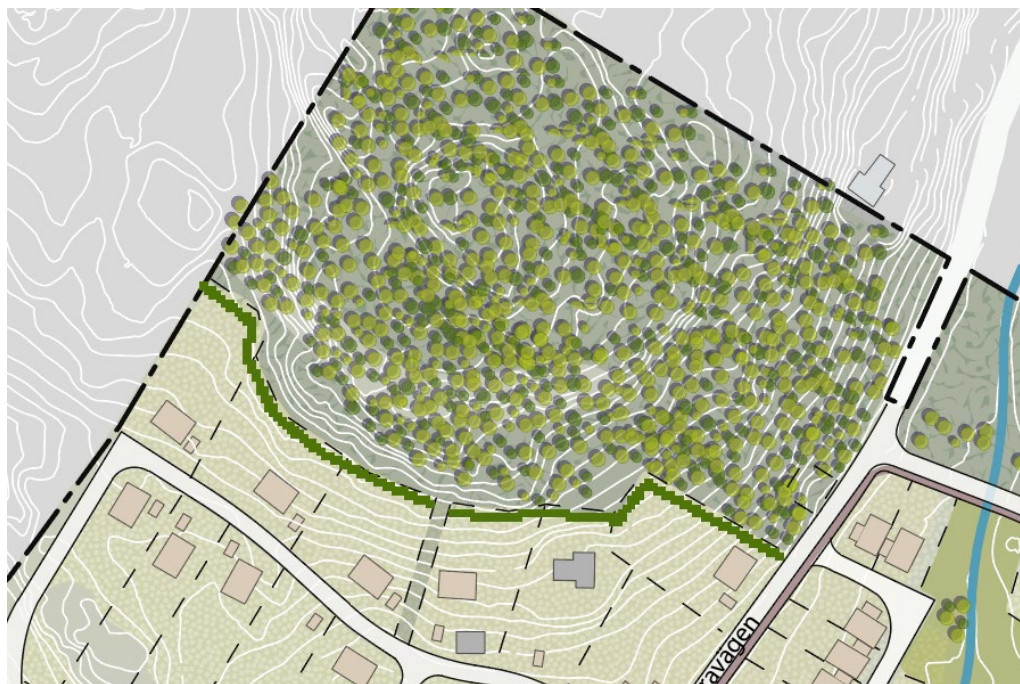
Figur 42 Avskärande vall eller mindre mur i grönt på kvartersmark för hantering av skyfall.
