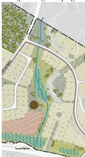
Figur 16 Ett befintligt dike och ett odlingsröse omfattas av det generella biotopskyddet. Diket med anslutande torrdammar för skyfallshantering illustreras med blått. Odlingsröset som ligger inom föreslagen allmän platsmark illustreras med brun cirkel.
