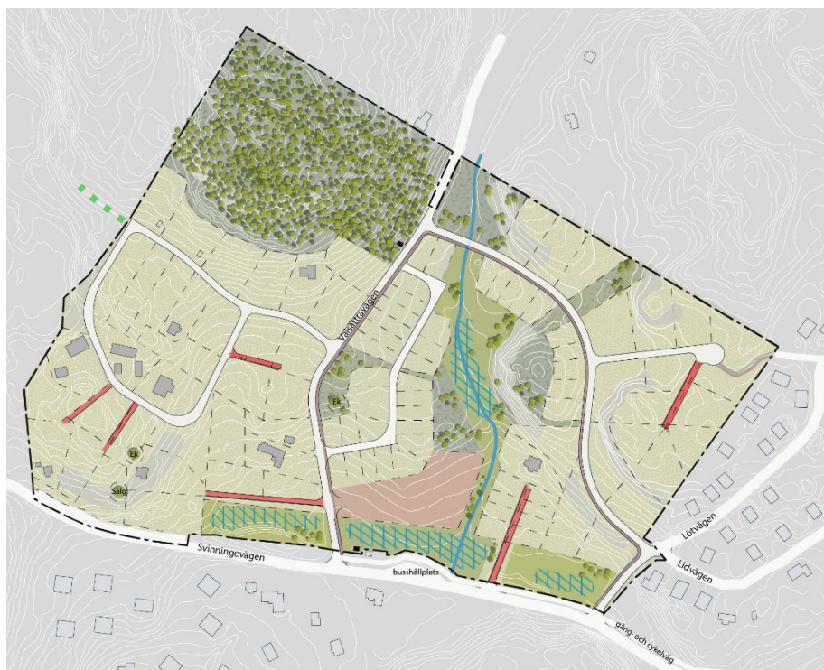
Figur 29 Bild på kommunala och enskilda vägar. De vita vägarna föreslås bli kommunala vägar och de röda enskilda. Grå streck längs rundslingan illustrerar trottoar och rosabrun linje i nordöst illustrerar gång och cykelväg som kopplar ihop rubricerad detaljplan med Valsättra del 1.
