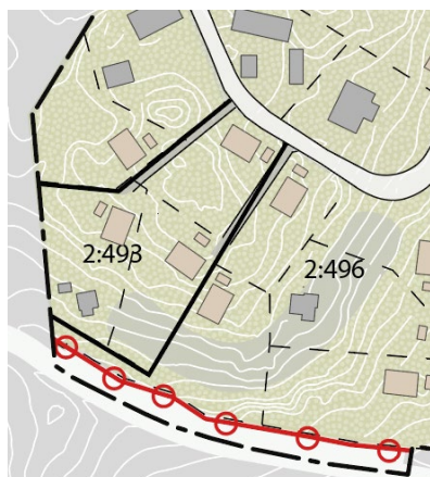
Figur 31 Idag finns utfart direkt till Svinningevägen från fastigheterna Svartgarn 2:493 och 2:496. Utfarten föreslås tas bort i och med planens genomförande. Illustrationen visar föreslaget utfartsförbud längs med Svinningevägen. (röda linjer).
