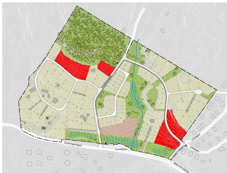
Figur 25 Bild som visar föreslagna områden där suterränghus krävs för att passa in i miljön. Sutrerränghus kan även förläggas på andra fastigheter men är då inget krav enligt detaljplanen. Illustration av Landskapslaget.
