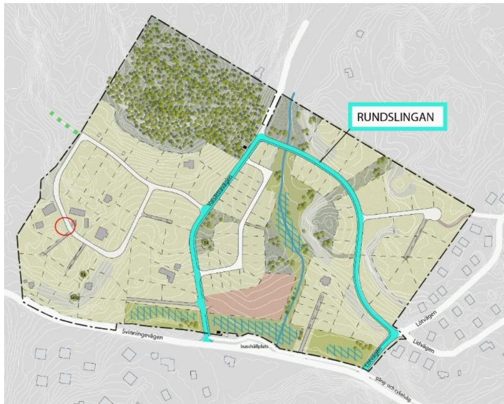
Figur 3 Kartbild som visar föreslagen gatustruktur i vitt och den så kallade rundslingan i turkos. De vita gatorna och den turkosa gatan föreslås bli kommunala. Rundslingan förses med gångbana och belysning. I väster är en del av vägen inringad där en avsmalning av vägen görs.
