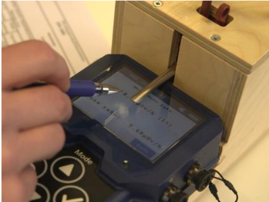
Saphyrad-S placerat i intensimeterprovaren "kyrkan". Foto: MSB
