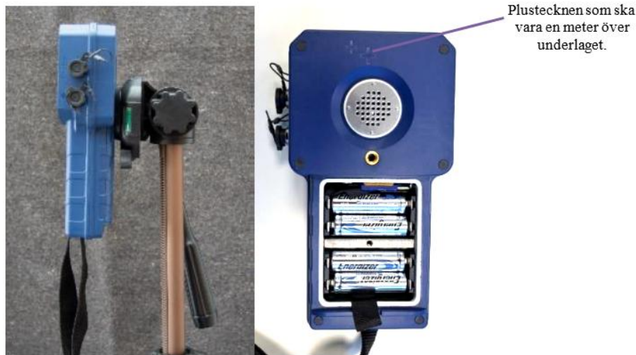
Saphyrad från sidan monterad på stativet. Plustecknen på baksidan används som markör för avståndet 1 meter till underlaget. Foton: Hans Källström (MSB)
