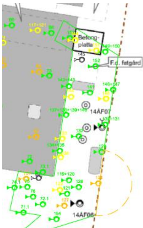
Figur 9. Provpunkter i anslutning till schakt av oljeavskiljare, spilloljecistern (närmast "Betongplatta") samt eldningsoljecistern (längre söderut). Grön linje anger schaktväggar som uppfyller åtgärds målet, streckad linje i orange anger schaktvägg där slutprov överstiger åtgärds målet. Provpunkternas respektive färg anger provets klassificering enligt; orange- >MKM<FA, gul- >KM<MKM, grön- <KM, svart- fältanalys. För fullständig situationsplan och provpunkter se bilaga 1.
