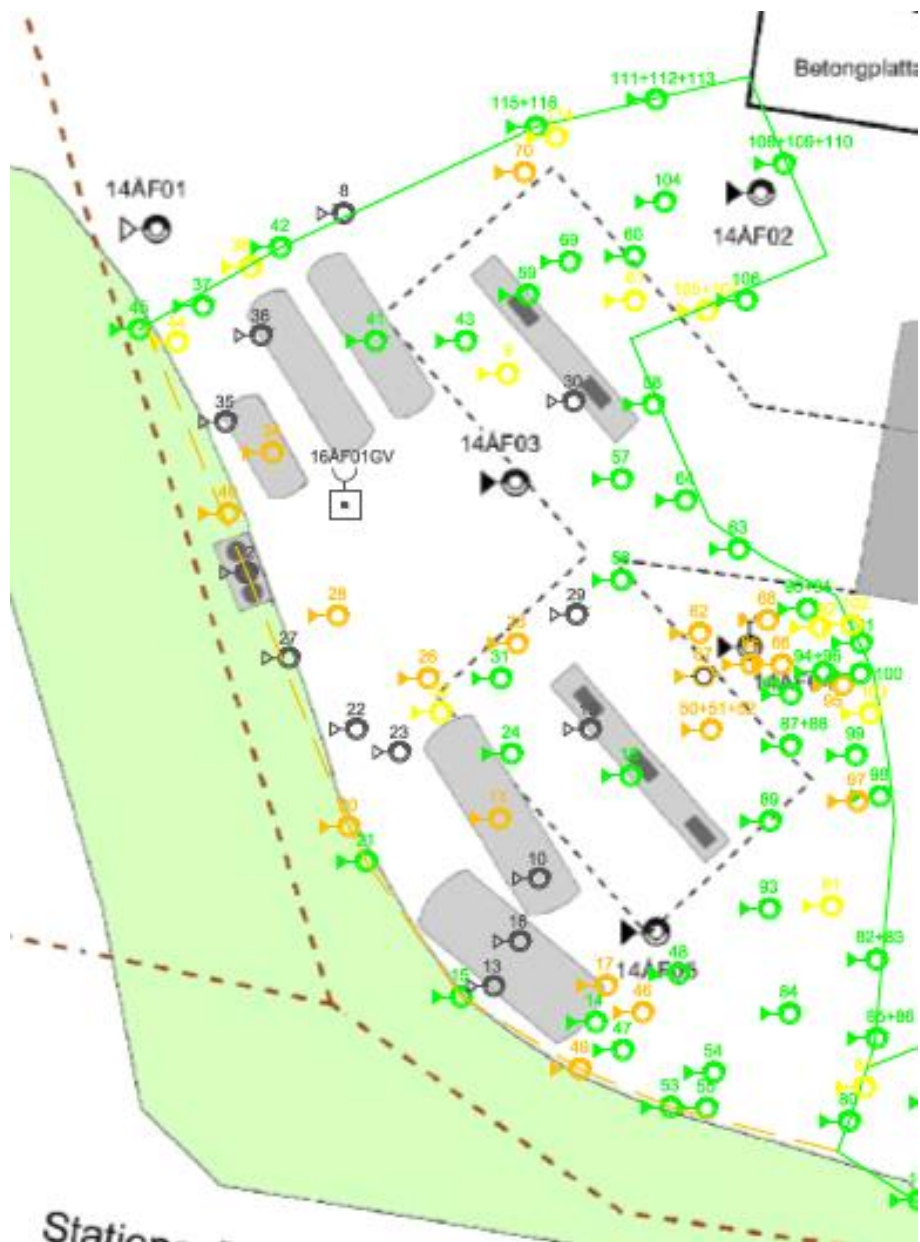
Figur 5. Del av situationsplan kring cisternområdet samt pumpöar. Grön linje anger schaktväggar som understiger åtgärds målet, streckad linje i orange anger schaktvägg där slutprov överstiger åtgärds målet. Provpunkternas respektive färg anger provets klassificering enligt; orange- >MKM<FA, gul- >KM<MKM, grön- <KM, svart- fältanalys. För fullständig situationsplan och provpunkter se bilaga 1.
