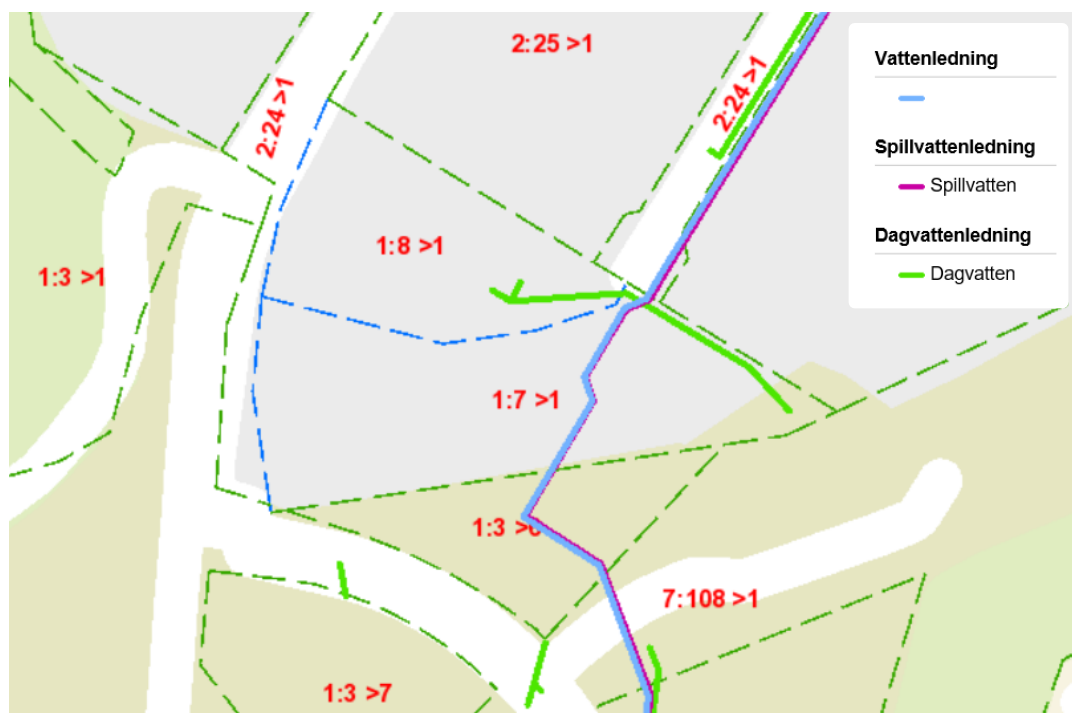
Figur 18. Karta över befintliga dagvatten-, spill- och vattenledningar inom området.
