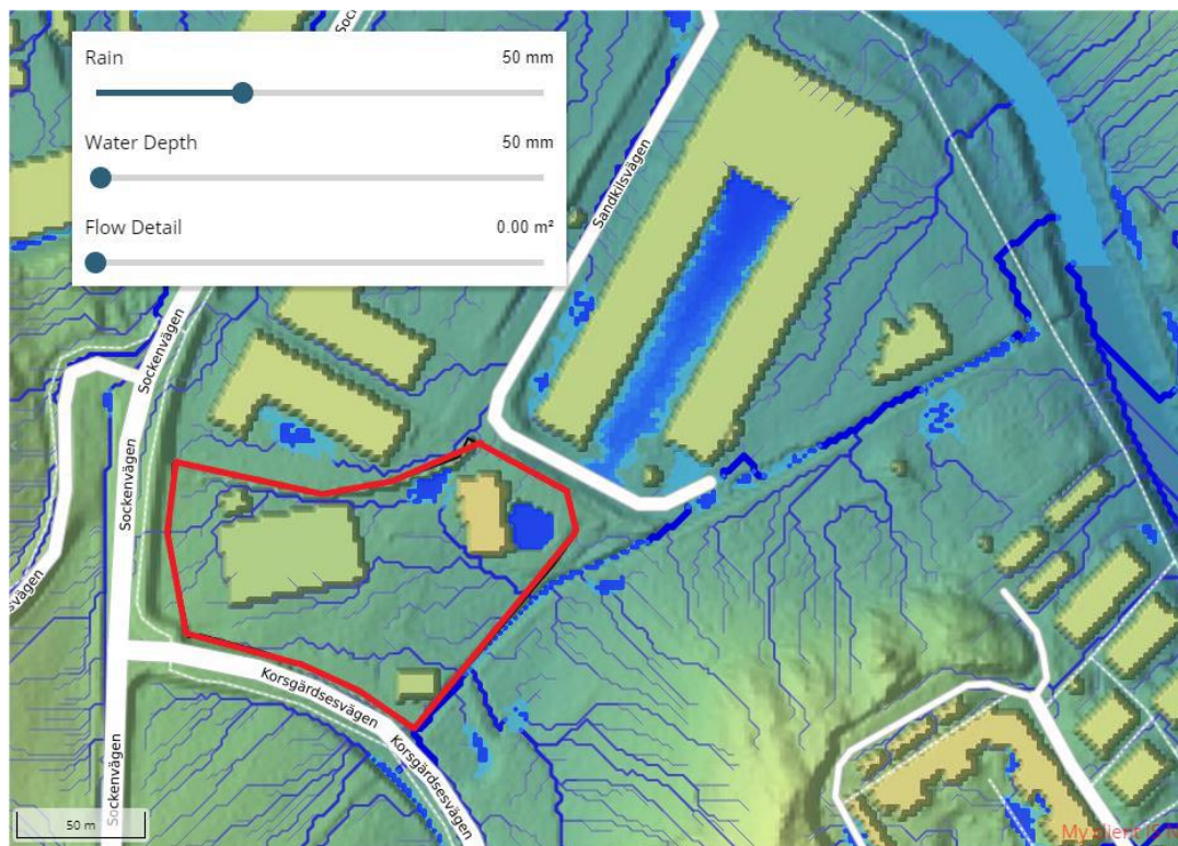
Figur 20. Översvämmade områden med vattendjup mer än 50 mm med hänsyn till ny byggnad, framtida situation är markerade med blått. Plangränsen är markerad med röd linje. (Dagvattenutredningen)
