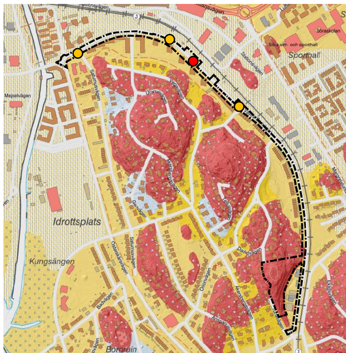
Figur 11. SGU:s jordartskarta med höjdskuggning. Röd punkt markerar plats där kvicklera påträffats i borrhpunkt. Orange cirkel visar plats där högsensitiv lera påträffats.
