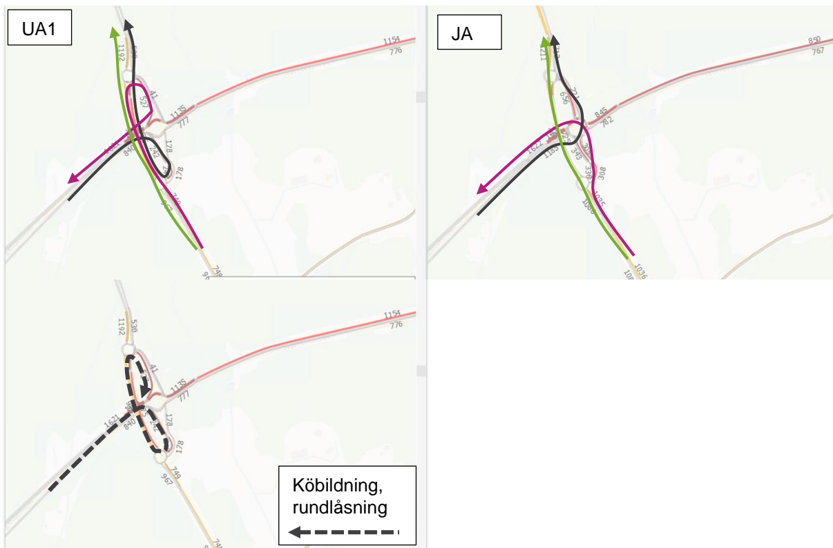
Figur 6-15. Ett urval av förändringar i rutt till följd av ombyggnad enligt UA1 i trafikplats Mossen. Risk för rundlåsning i streckad linje i UA1.
