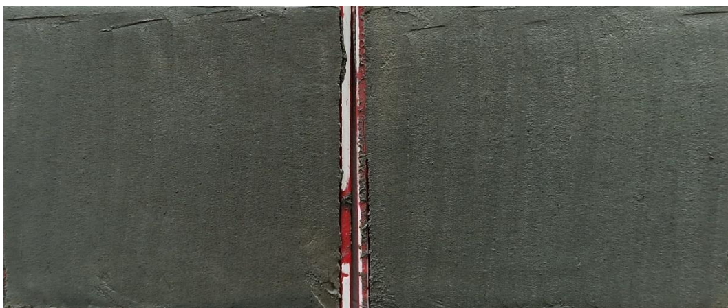
Figur 3 Borrpunkten, 23B09, 2,0 m, Jordprovet i nedre delen av mellanhylsan delad longitudinellt provhylsan med id Bjerking 750.
