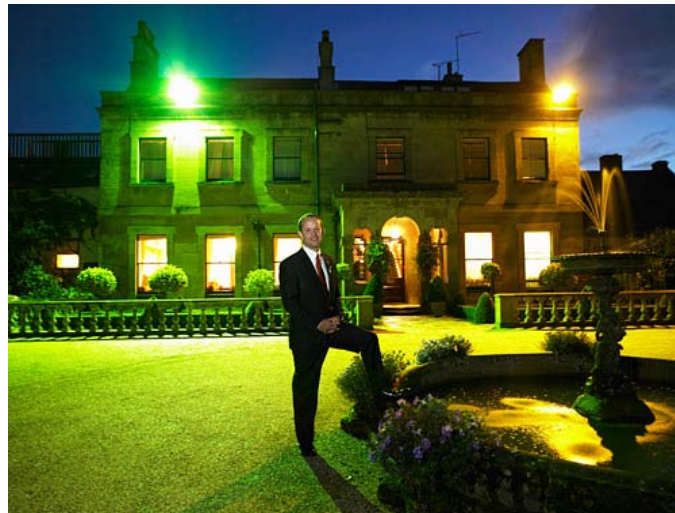
Till vänster kvicksilverljuskälla och till höger högtrycksnatrium. Kameran framhäver det gröna i kvicksilvret.
