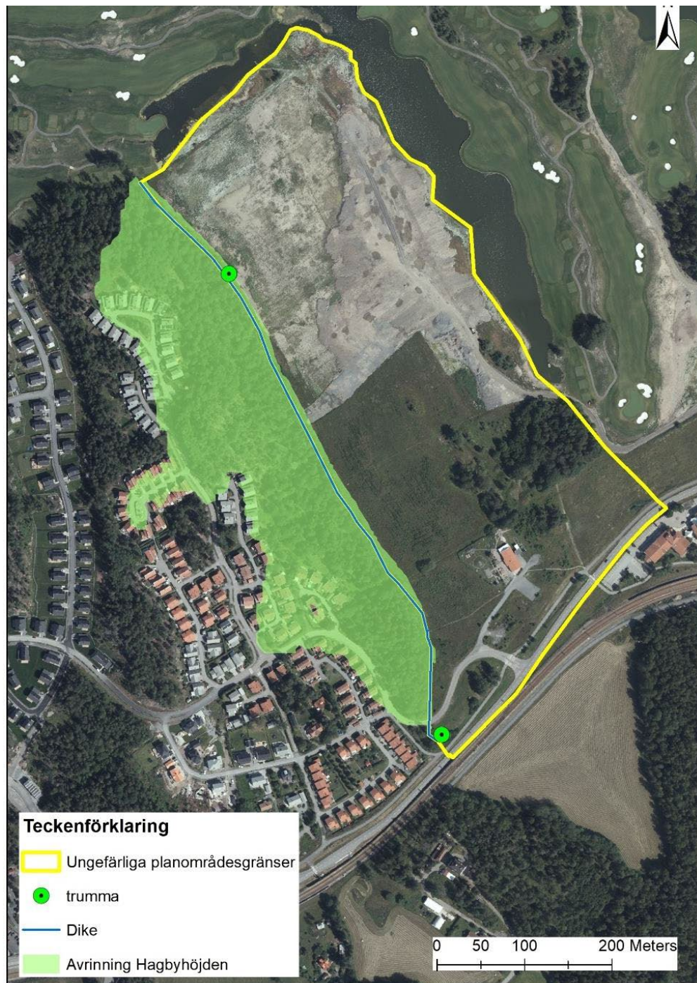
Figur 41. Avrinningsområde till diket väster om planområdet. Diket avleder dagvatten från del av Hagbyhöjden, naturmark samt del av planområdet. Gröna punkter avser befintliga trummor.
