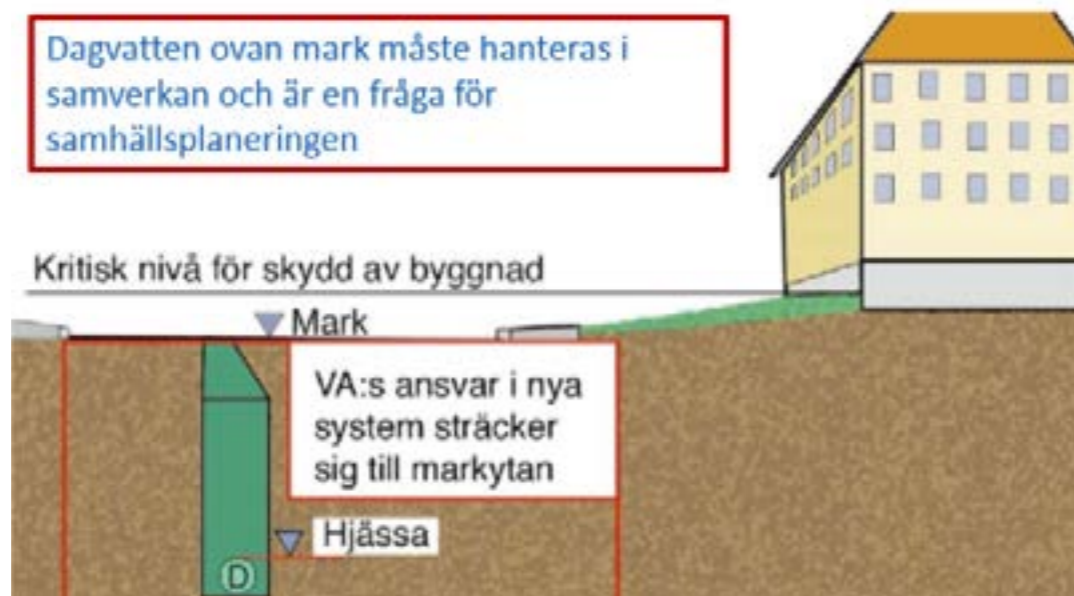
Figur 1. Funktionskrav för nya dagvattenledningar (Källa: P110)
